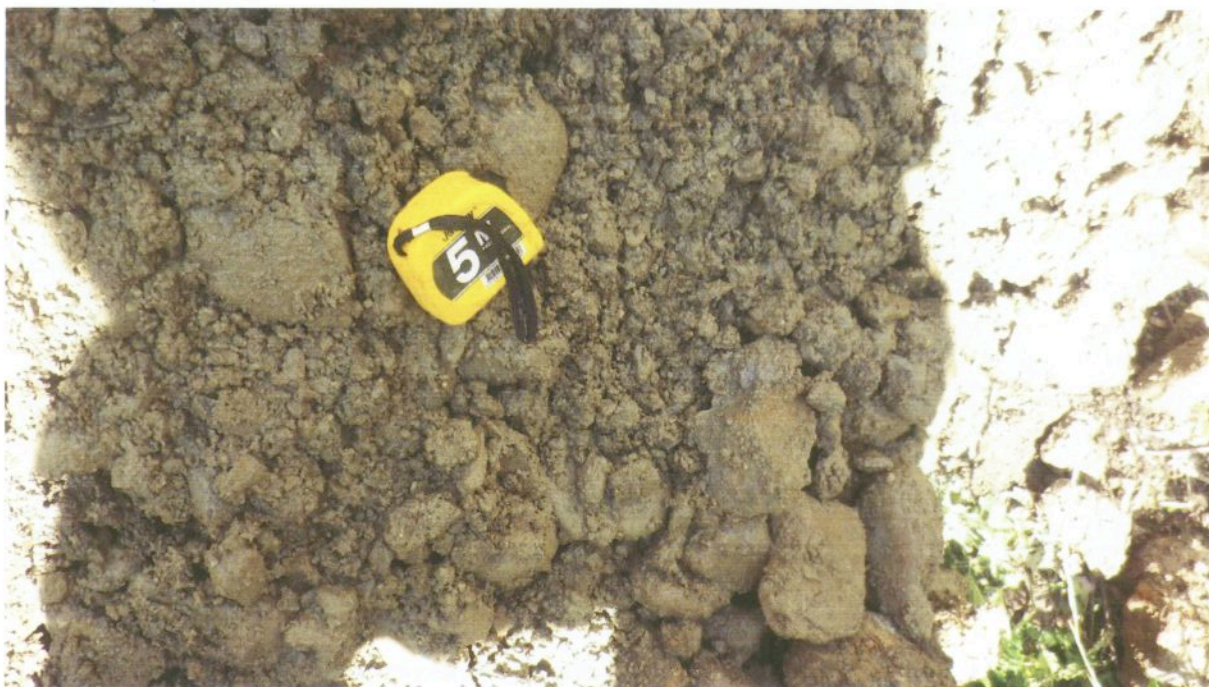
Obrázek 7 Sonda výtah - detail štěrkopískové terasy
